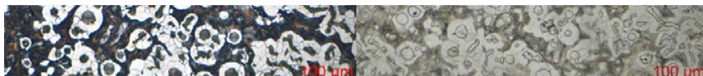
Hierro Fundido - Micrografía original - 100x
